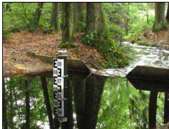
Piezometr do automatycznego pomiaru parametrów wód płynących z łatą wodowskazową
