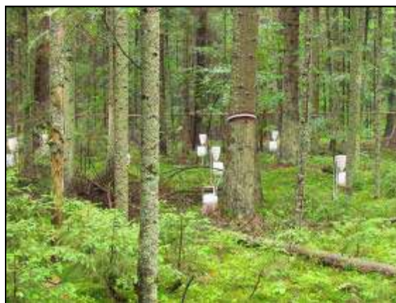
Pomiary opadu podkoronowego, spływu po pniach, opadu organicznego oraz właściwości wód glebowych
